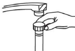
Raccordez fermement le raccord droit du tuyau d'alimentation à l'alimentation en eau en veillant à ce que les rondelles soient bien positionnées aux deux extrémités du tuyau.
