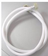
Le tuyau d'alimentation en eau de l'appareil se termine par un raccord femelle  $\frac{3}{4}$ " (1,9 cm). L'alimentation en eau doit donc être pourvue d'un raccord mâle similaire et d'une canalisation avec robinet d'arrêt à proximité.
